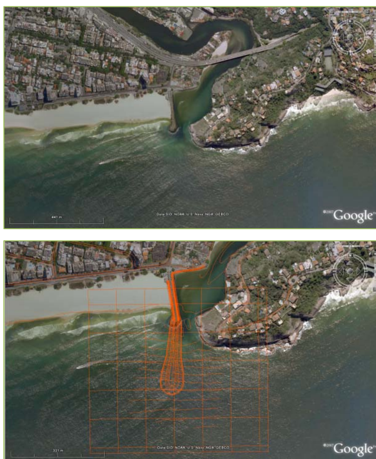
Figura 1.3.14-1: Imagem atual da área de estudo (acima) e projeto de extensão do guia corrente (abaixo). Observa-se na saída do Canal da Joatinga, o guia corrente e a faixa de areia “engordada” pelo transporte sedimentar da deriva litorânea.
