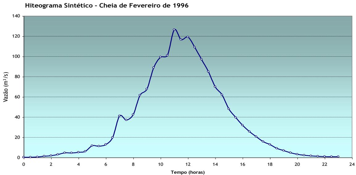
**Figura 11.** Hidrograma sintético afluente à LRF correspondente às chuvas entre 12 e 13/02/1996. Este hidrograma representa uma distribuição temporal do volume acumulado na lagoa, e atinge picos de vazão afluente à LRF muito acima das estimativas de vazões máximas com período de retorno de 20 anos.
