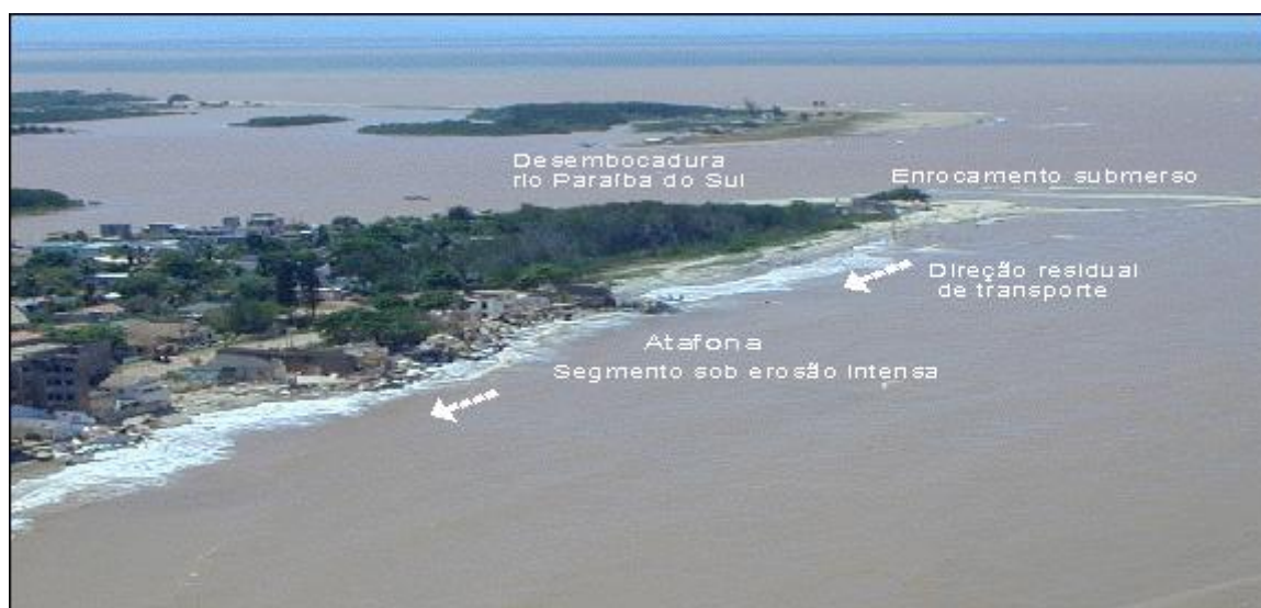
Figura 48.. Vista do pontal de Atafona, na margem direita do delta do rio Paraíba do Sul. É visível o grave problema de erosão costeira na localidade.
