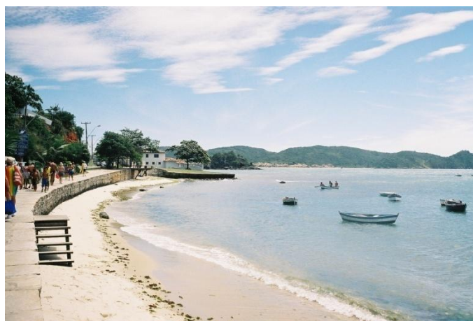
Figura 54: Urbanização da orla em Búzios. Observar a estreita faixa de areia e o muro vertical, que propicia a reflexão das ondas.
